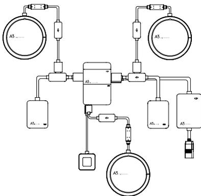
\*A3 Pro 冗余的 GPS-Compass Pro 模块与标准版的外观和功能一样；IMU Pro 模块内置 IMU 和气压计，其功能与主控器内置的 IMU 和气压计一样。
